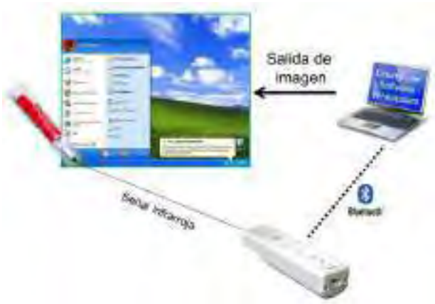
Figura 3: Diagrama de Conexión para replicar un PDI mediante el software Wiimote Whiteboard
