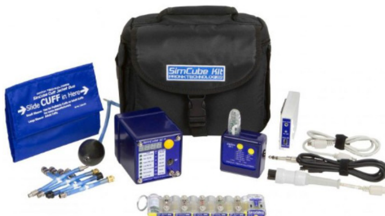
Figura 15. Simulador para hemodinámica SIMCUBE (simulador para ECG, SpO 2 , temperatura, IBP e NIBP y GC)
