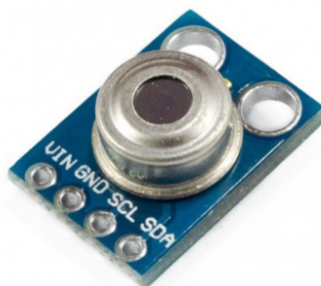
Figura 10. Módulo para la medición de temperatura MLX90614
