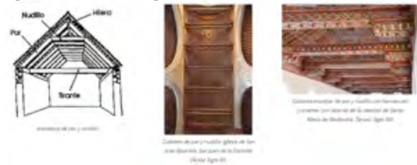
Figura 16. Grafico de par y nudillo, y ejemplos de aplicación en la arquitectura.
